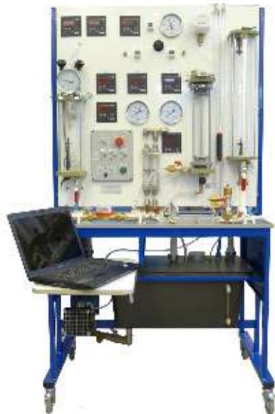
Измерительные приборы давления, расхода, температуры
