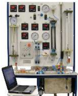
Измерительные приборы давления, расхода, температуры
