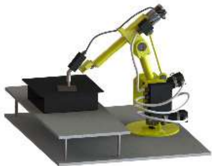
Сварочная ячейка на базе робота «ROBIN WELD1»
