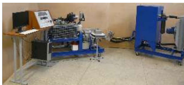
«Рабочие процессы 4-цилиндрового бензинового/дизельного двигателя с мотор-генераторной или гидравлической нагружающей установкой»
