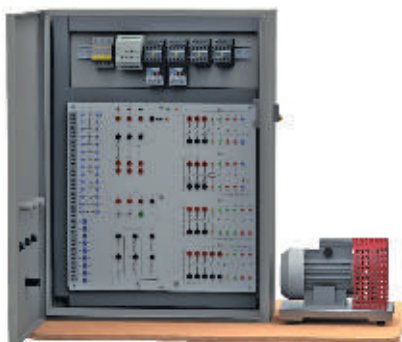
Система управления двухскоростным асинхронным двигателем с короткозамкнутым ротором
