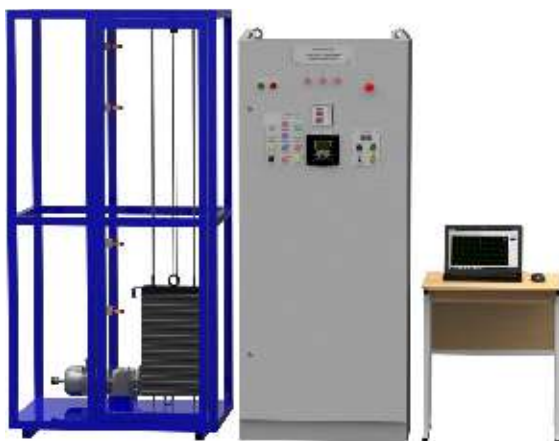
Электрооборудование подъемного крана
