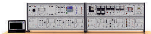
Устройства компенсации реактивной мощности
