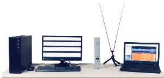
Защита информации от утечек по каналу побочных ЭМИ
