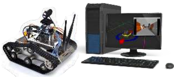
Аппаратно-программный комплекс для исследования методов навигации и наведения на основе оптических сенсоров
