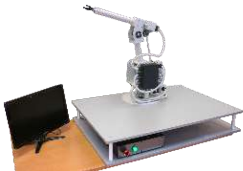
Учебный электромеханический робот с 3-мя степенями подвижности Робин РСС-1 Сфера USB
