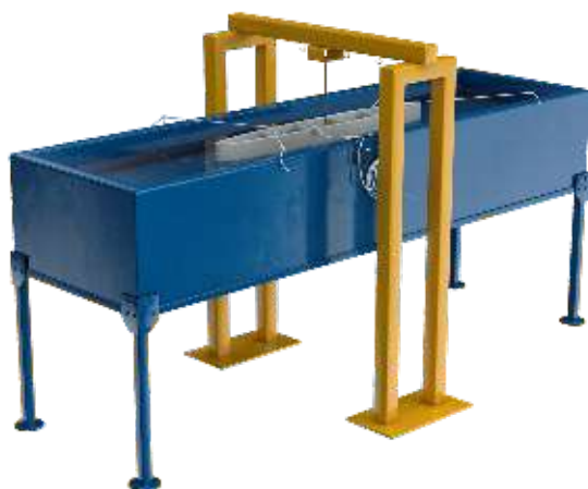
Учебный стенд «Вибрационные испытания судов»
