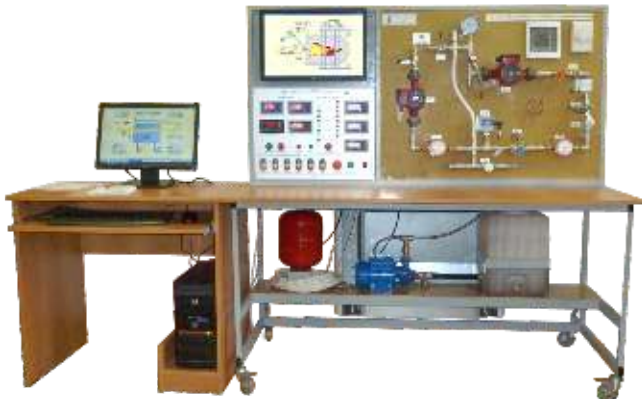
«Автоматизированная котельная на жидком и газообразном топливе»
