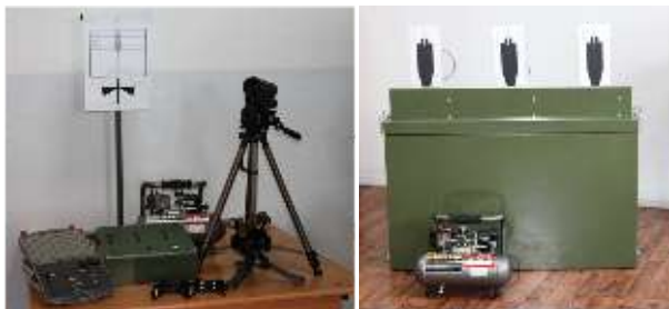
Тренажер-имитатор «Лазерный имитатор прицельных приспособлений (лазерный патрон)»
