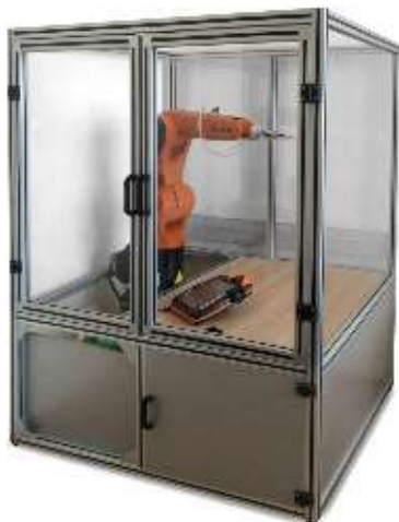
Роботизированная сборочная ячейка на базе промышленного робота KUKA KR6 R700 с техническим зрением KUKA VISION
