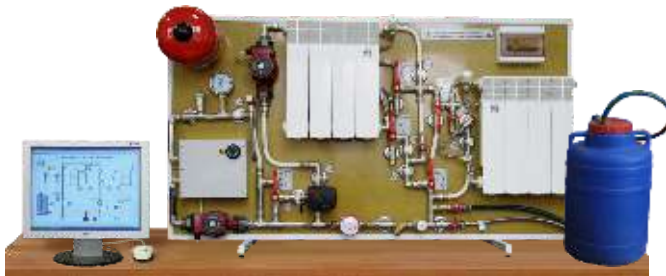
Автономная автоматизированная система отопления
