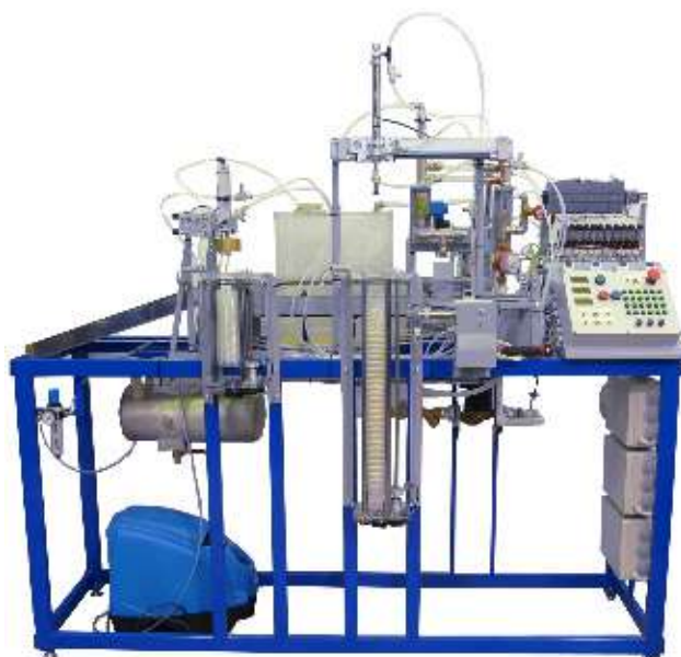
Автоматизированная линия дозирования и упаковки жидкости
