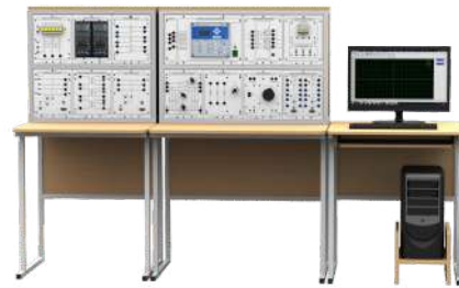
Терминал релейной защиты и автоматики кабельной линии
