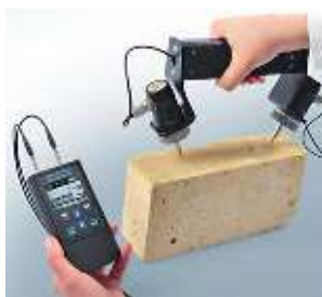
Ультразвуковой контроль бетонных конструкций
