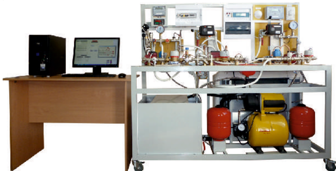
Автоматизированный тепловой пункт
