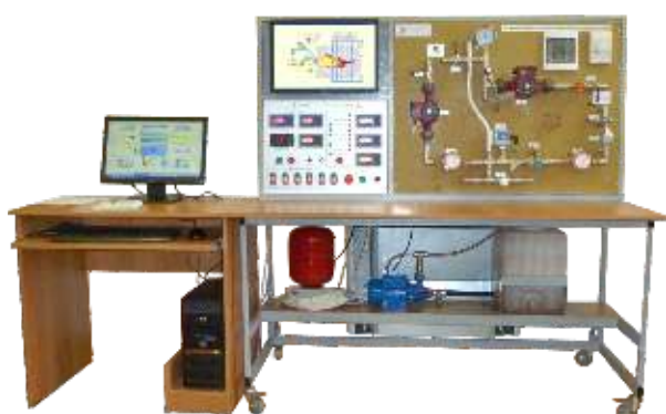
Автоматизированная котельная на газообразном топливе
