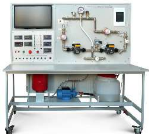
Автоматизированная котельная на твердом топливе
