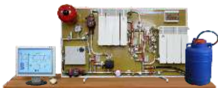
Автономная автоматизированная система отопления
