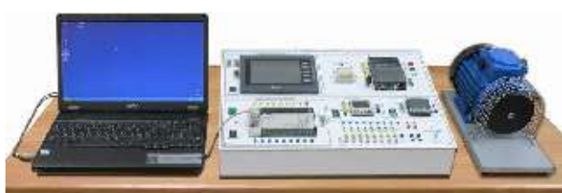
Промышленная автоматика – программируемый контроллер и преобразователь частоты фирмы DELTA
