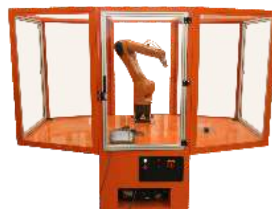
Роботизированная сборочная ячейка на базе промышленного робота KUKA Kr10
