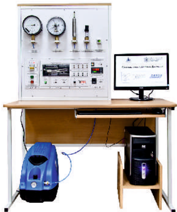
Система автоматического управления давлением
