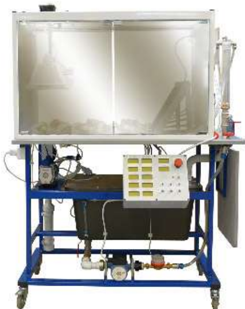
Возобновляемые источники энергии. Солнечный коллектор
