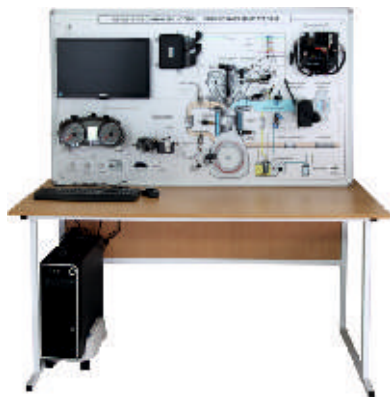
Мультиплексорная CAN система управления бензиновым двигателем
