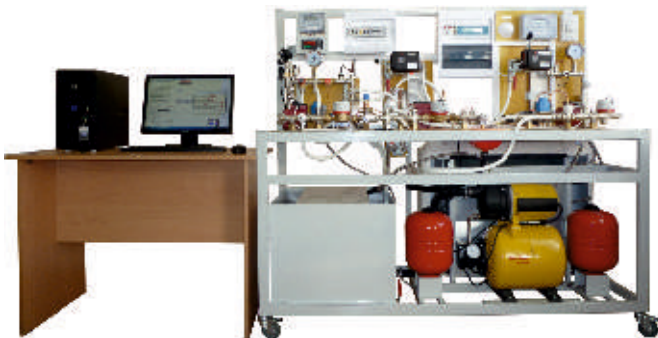
Автоматизированный тепловой пункт
