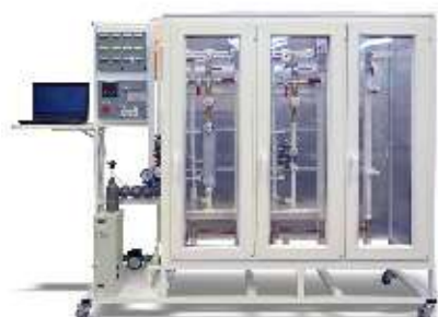
Тепловые и гидравлические характеристики приборов отопления
