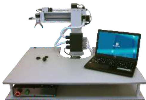
Автоматизированный сборочный стенд с компьютерным управлением и техническим зрением
