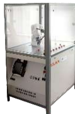
Роботизированная сборочная ячейка на базе промышленного робота KUKA Kr3
