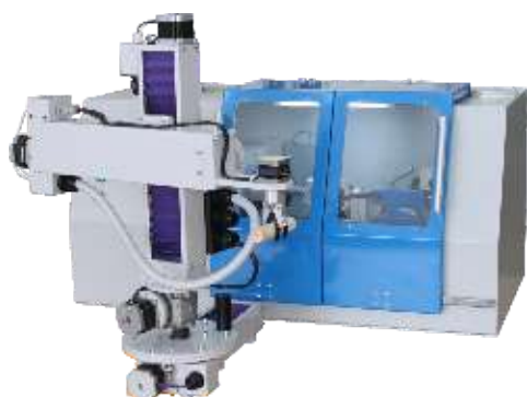
Гибкий производственный модуль с компьютерным управлением на базе настольного токарного станка и учебного робота ГПМ-Т-Робин Ц1
