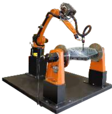
Сварочная ячейка на базе промышленного робота КУКА
