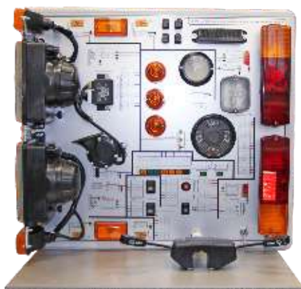
Система освещения и сигнализации грузового автомобиля
