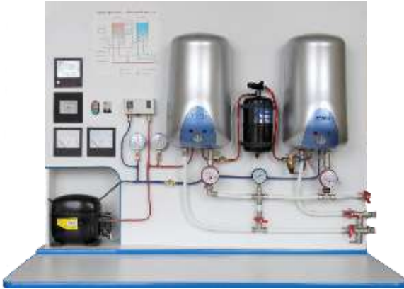
Тепловой насос с использованием геотермальной низкопотенциальной энергии
