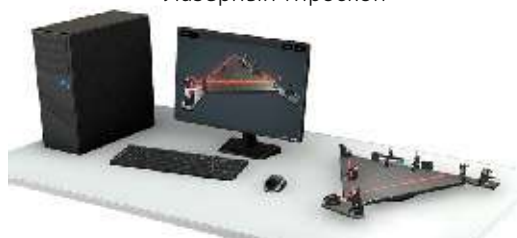
Лабораторный стенд «Принцип работы лазерного гироскопа» (изучение эффекта Саньяка)
