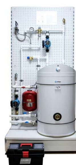
Макет жилого здания с отображением систем ЖКХ
