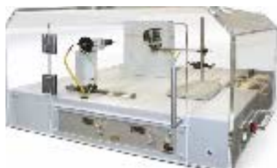
Производство неориентированного нановолокна методом электроспиннинга (ЛК-НМ-ЭС-2)
