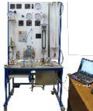
Измерения давлений, расходов и температур в системах водо- и газоснабжения
