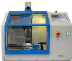
Настольный фрезерный станок с компьютерным управлением и компьютерными имитаторами токарного и фрезерного станков (УФСп-ЧПУ-USB)
