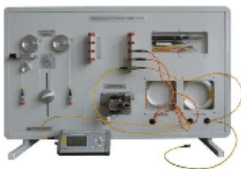
Волоконно-оптическая линия связи (ВОЛС-02)
