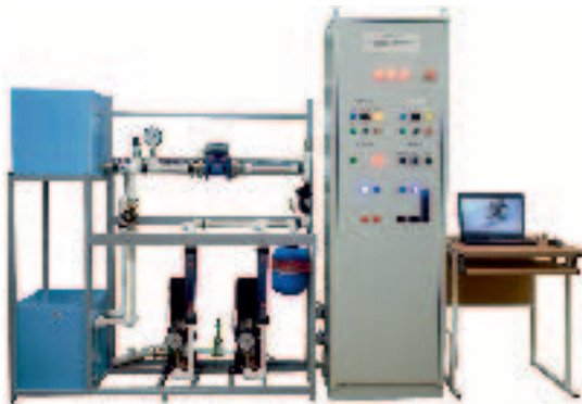
Электрооборудование и автоматика насосной установки (ЭОиА-НУ-ШН)
