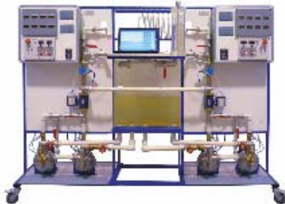
Система управления насосной перекачивающей станцией
