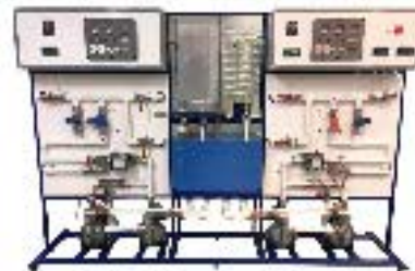
Управление насосной перекачивающей станцией систем водоснабжения
