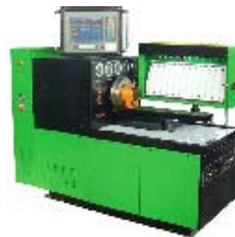
Испытания и регулировка ТНВД
