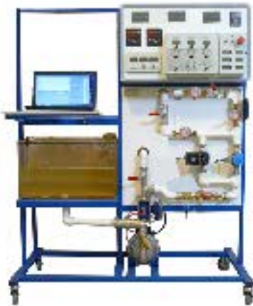
Применение средств автоматизации и диспетчеризации в системах водоснабжения
