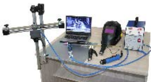
Малоамперный дуговой тренажер сварщика (ДТС-К)
