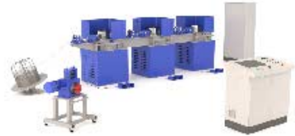
Обработка металлов давлением. Многократное волочение
